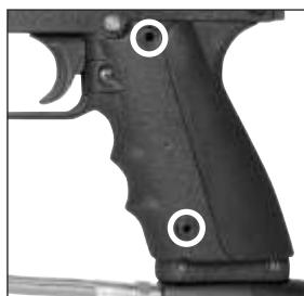
Выкрутите 2 болта крепления модуля рукоятки торцовым внутренним ключом на 5/32" или выньте 2 фиксирующих модуль штифта, чтобы расфиксировать модуль AEC.
