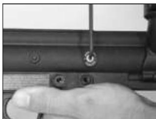
Рисунок 6. Торцовый внутренний ключ на 1/8", используемый для регулирования скорости вылета.
