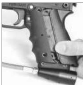
Чтобы получить доступ к турнирному блокировочному переключателю, отсоедините модуль AEC от приемника.
