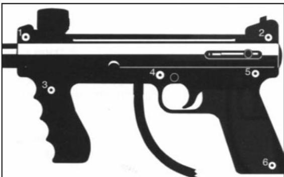
Замечание: Предохранитель остается на левой половине корпуса, повторная сборка которой должна осуществляться в последовательности, точно соответствующей обратной последовательности разборки.
