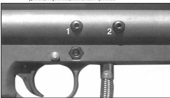
Чтобы отсоединить газовую камеру и ее корпус, выкрутите два болта крепления газовой камеры в наружной части правой половины корпуса.
