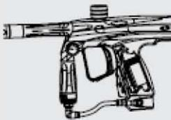
При помощи ключа 5/64" открутите два крепежных винта с левой стороны рукоятки и откройте панель. Подсоедините новую 9-вольтовую щелочную батарею к контактам (зажимным скобам). Расположите батарею внутри рамы рукоятки, спрятав все провода под ней. Закрутите панель.
