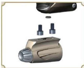
Если ASA устанавливается непосредственно на рукоятку, то фиксирующие винты должны быть размещены в специальном пазу, в верхней части адаптера. После того, как адаптер будет присоединён к рукоятке, винты можно закрутить, используя 5/32 шестигранный ключ, через технологические отверстия в нижней части ASA.
