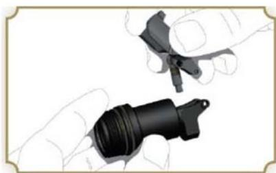
Сборка болтовой группы производится в порядке, обратном разборке.
