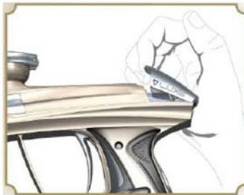
После того, как весь воздух из пневматической системы маркера удалён, можно приступать к операциям по его обслуживанию. Во избежание постановки газового тракта под давление, оставьте заднюю крышку открытой. Отсоедините от маркера воздушный баллон. Во время откручивания баллона от маркера следите, чтобы регулятор баллона выкручивался из ASA, а не колба баллона откручивалась от регулятора.
