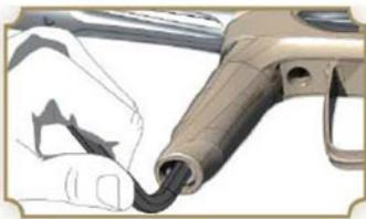
*Разборка и обслуживание регулятора изменит выдаваемое им давление. Для установки корректной скорости полёта шара, потребуется повторная настройка регулятора.*
