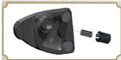
Протрите накладку, при необходимости, можно воспользоваться спиртосодержащим очистителем. После этого, вставьте пружинку в тыльную сторону фиксатора шара, и поместите его в гнездо на накладке. Вы должны вставить, и слегка прижать фиксатор шара для того, чтобы он полностью встал на свое место. Будьте аккуратны с пружинкой, если при постановке фиксатора шара его перекосит, и он соскользнет с накладки, пружинка может резко распрымиться, и улететь.
