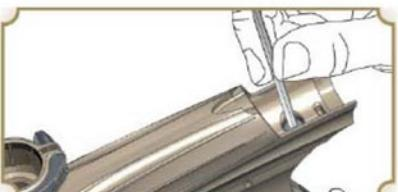
Сборка осуществляется в обратном порядке. Чрезвычайно важно, чтобы провода оптической системы и соленоида были правильно уложены. В противном случае, при сборке корпуса и затягивании фиксирующих винтов, возможно повреждение проводных шлейфов. Также, важно правильное подключение к плате шлейфа оптической системы. Для этого используется коннектор специальной формы.
